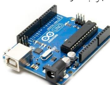
شکل ۳. برد آردوینو Uno مبتنی بر میکروکنترلر ATmega328
